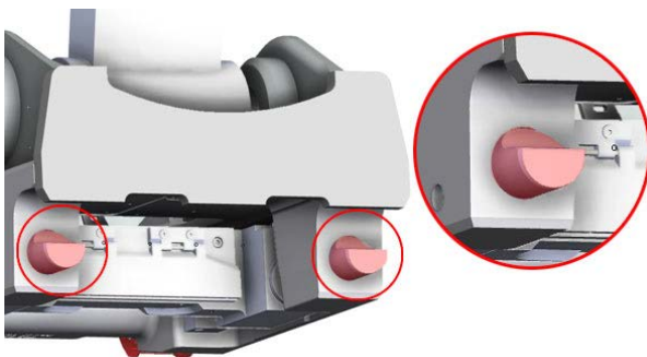
Abbildung 116: H-Zylinder in verriegeltem Zustand
