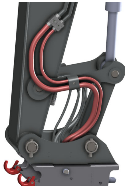
Abbildung 79: Löffelzylinder in mittlerer Stellung
