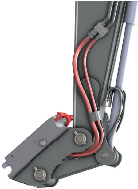
Abbildung 80: Löffelzylinder ganz ausgefahren
