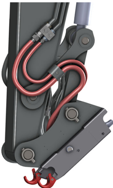
Abbildung 78: Löffelzylinder ganz eingefahren
